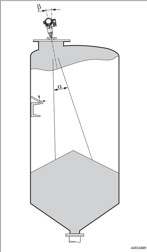
安装在斜面上的金属反射板会散射雷达波信号；因此，可以减少干扰回波。
