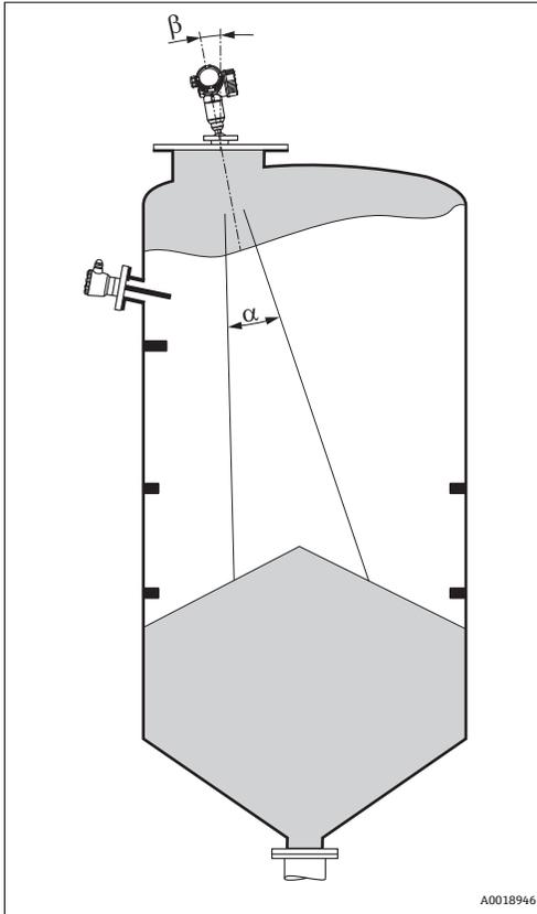
在信号波束范围内避免安装任何装置 (例如: 限位开关、温度传感器、支撑等)。注意波束角  $\rightarrow$  图 16。
